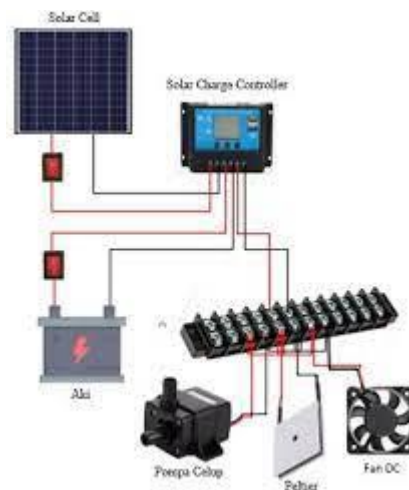
Gambar 2: Desain Rancangan Cooler Box Udang
